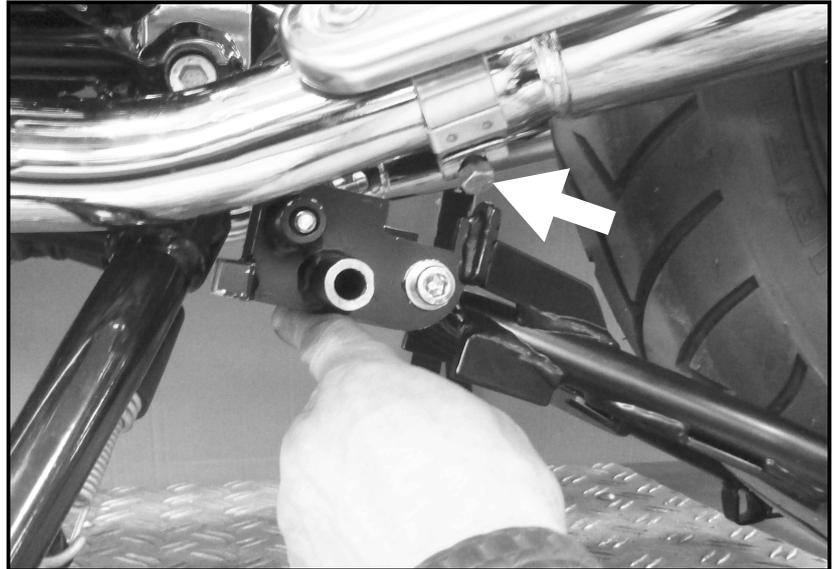
Halteadapter ausrichten und mit der
