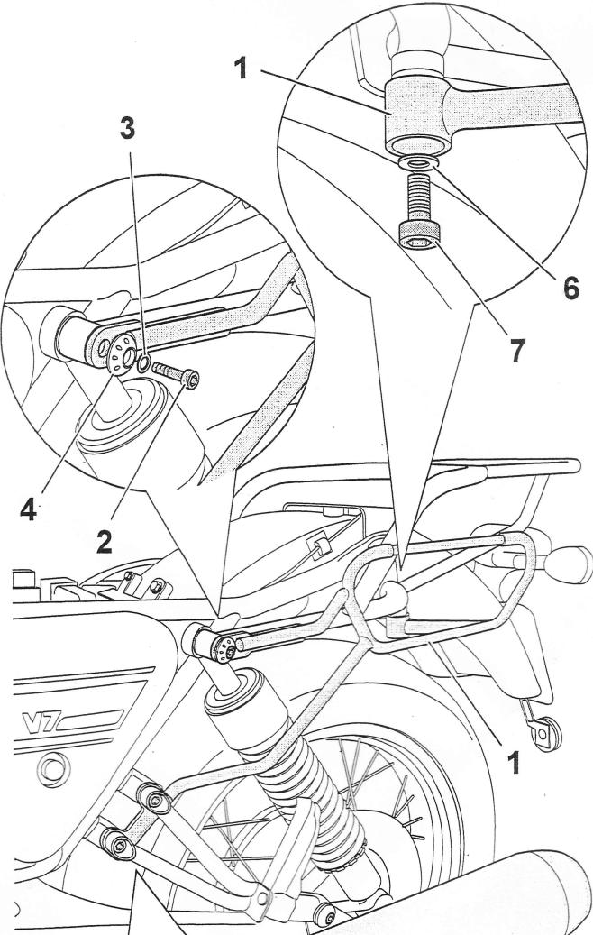
**D** Den linken Kofferträger 1 am Motorrad positionieren, die Schraube 2 (M6x50) mit der Unterlegscheibe 3 und der Aluminiumbuchse 4 festschrauben.
