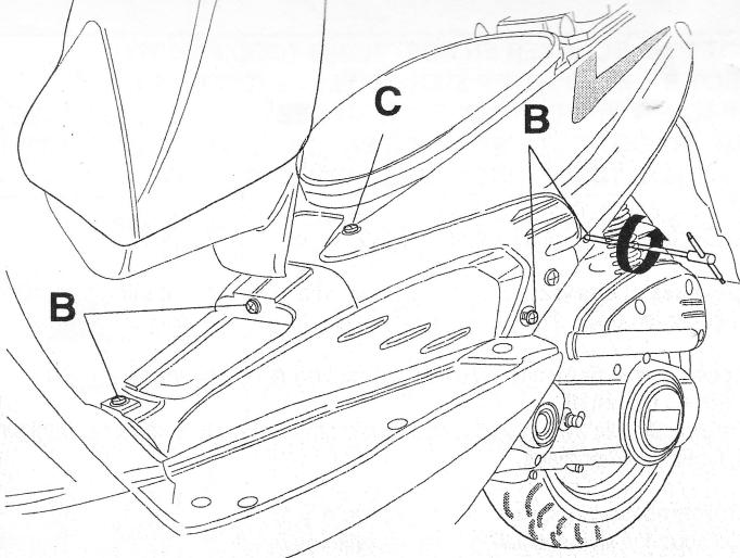
Svitare e togliere le viti **B** di fissaggio fiancatina e le due viti **C** di fissaggio parte anteriore del codone.
