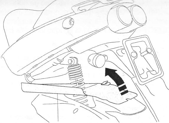
Posizionare il supporto MINIROBOT come da disegno, avvitare parzialmente i due dadi 7 M8; tramite le due viti 8 TBEI M8x14 e le rondelle di sicurezza 9 fissare la parte anteriore del MINIROBOT sugli attacchi anteriori.
