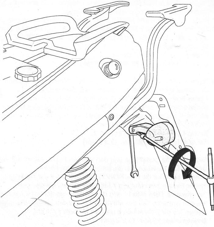
**I** Riassemblare le due frecce posteriori di direzione. Posizionare la piastra di aggancio bauletto (in dotazione al bauletto), accertarsi che questa non vada ad interferire sull'apertura/chiusura della sella e fissarla al supporto MINIROBOT tramite la minuteria in dotazione alla piastra.
