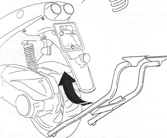
**F** Rassemblez les petits flancs et la carène inférieure sur le scooter. Démontez les deux flèches postérieures de direction. Placez le support MINIROBOT comme sur le dessin, vissez partiellement les deux écrous 7 M8; à l'aide des deux vis 8 TBEI M8x14 et des rondelles de sécurité 9 fixez la partie antérieure du MINIROBOT sur les attaches antérieures
