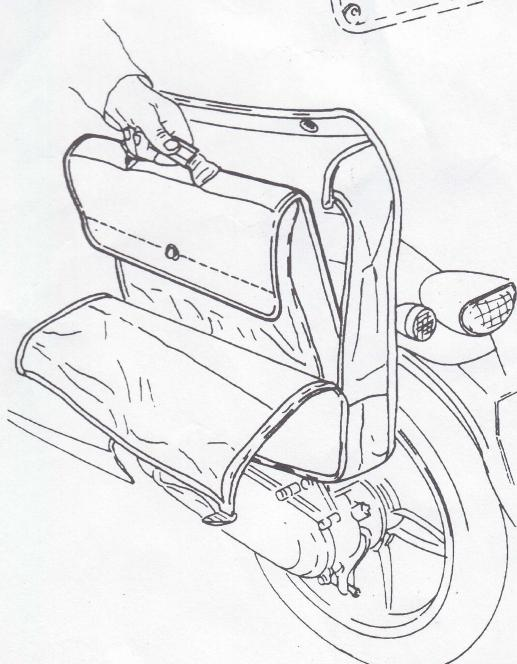
**I** Togliere il portapacchi, posizionare il supporto borsa e il distanziale 1 come indicato dal disegno fissandolo con le viti 2 (TCEI 6x50). Fissare il supporto al telaio del cicloscooter tramite la vite 3 (TCEI 8x18), e il dado autobloccante M8.
