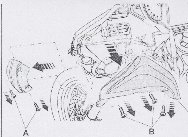
Die Schrauben A abschrauben und entfernen und den seitlichen Kühlergrill entfernen.
