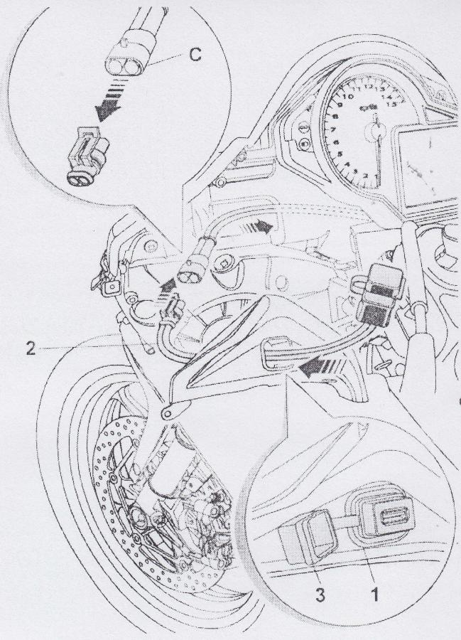
Von der Vorderseite des Kühlergrills das Kabel 2 der USB-Buchse 3 in die Bohrung von Gummi 1 einsetzen und die Buchse einsetzen. Dabei darauf achten, dass die Klappe sich nach links öffnet (längere Seite des Kühlergrills).
