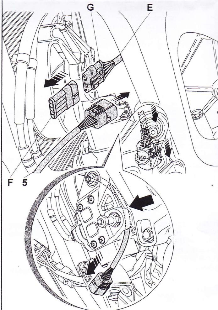
**F** Appliquer le caoutchouc adhésif mousse 1 sur la partie inférieure du calculateur V4-MP 2.
