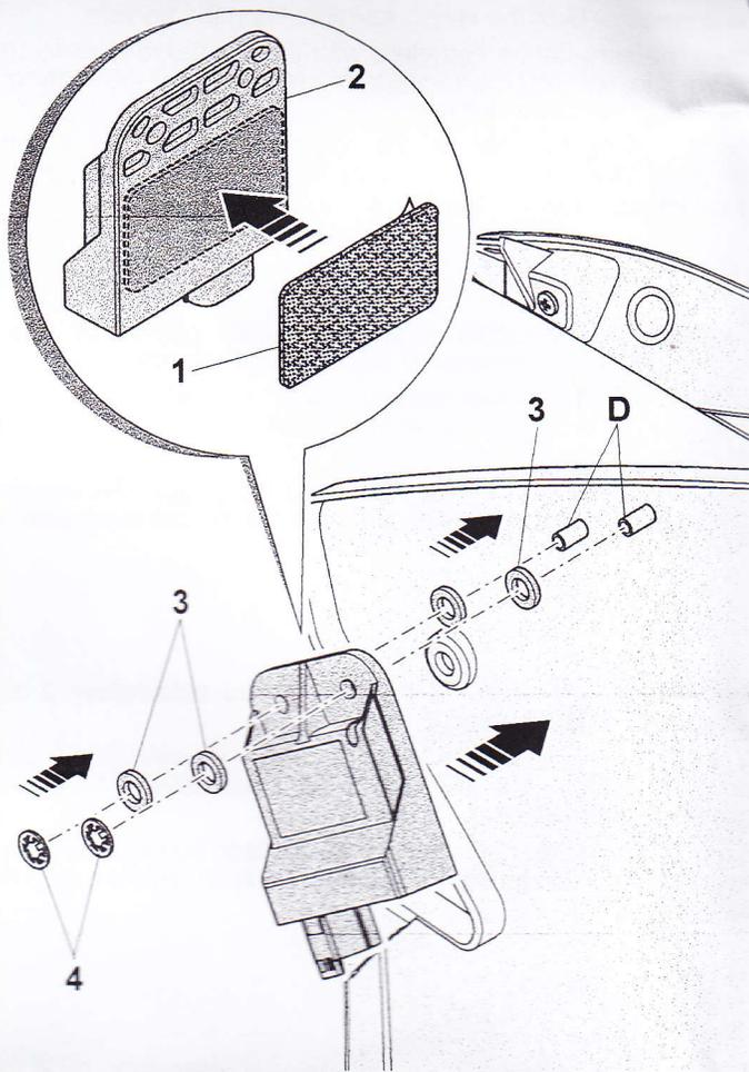
**D** Den Schaumstoffklebegummi 1 auf dem unteren Teil der V4-MP Steuerelektronik 2 anbringen.
