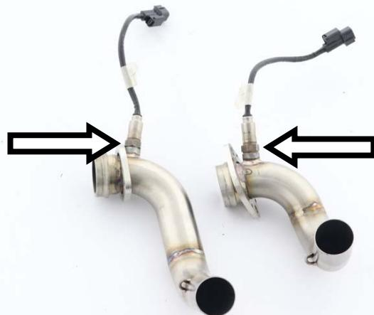
**IT** · Avvitare le sonde lambda nei collettori Arrow senza invertirle posizionando le flange come mostrato in foto
