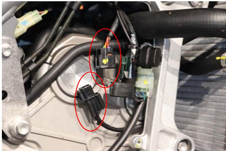
**IT** · Sfilare il connettore della sonda lambda DX dalla propria sede, disconnettere il cablaggio e liberare il cavo per poterlo rimuovere assieme ai collettori
