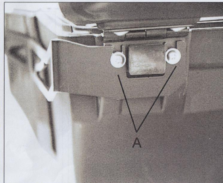
Dopo aver aperto la borsa per accedere ai dadi di fissaggio interni, allentate le viti originali nella posizione -A- senza rimuoverle
