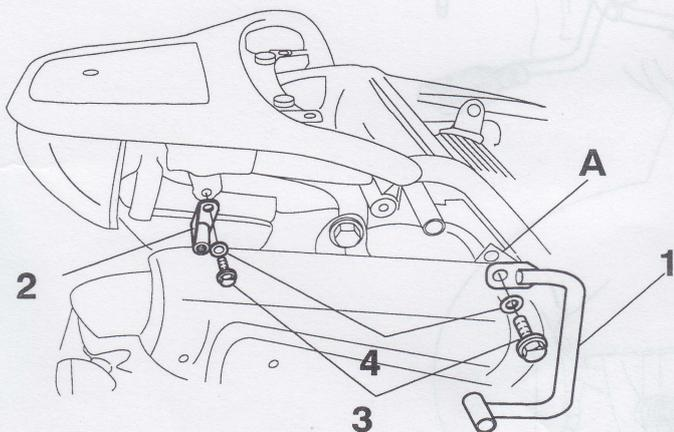
**I** Rimuovere la sella e le fiancatine; svitare la vite **A**, posizionare l'attacco anteriore **1** e l'attacco posteriore **2** tramite le viti **3** (TE 8x20) e le rondelle **4**.
