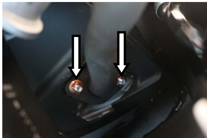
Svitare i dadi (2) dai prigionieri del cilindro Remove the bolts (2) securing the collector to the cylinder
