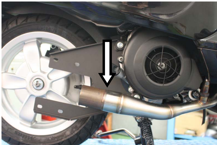
Innestare il catalizzatore (se presente) Fit catalytic converter
