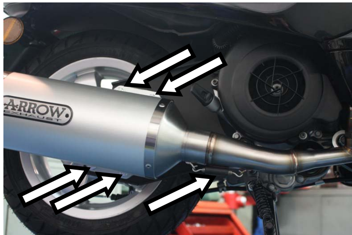
Innestare il terminale, serrare gli attacchi al telaio ed ancorare la molla. Serrare definitivamente il collettore al cilindro Fit the silencer, secure the silencer mounts to the bracket and tighten the bolts securing the collector
