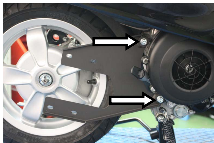
Avvitare al motore la staffa di sostegno terminale Fit the mounting bracket as shown above
