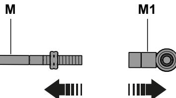
**D** Das untere Gelenk mit Linksgewinde (**M1**) von der Standardschaltstange (**M**) entfernen und an der Schaltstange (**2**) des Kits montieren. Die Quick-Shift-Vorrichtung (**1**) und die Schaltstange (**2**) des Kits zusammensetzen, dabei als Mittenabstand das gleiche Maß einstellen, das beim Ausbau der serienmäßigen Stange gemessen wurde (**X mm**). Nach Einstellung der Stangenlänge die Kontermuttern (**2A**) und (**2B**) anziehen.
