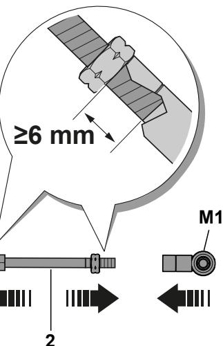
**E** Retire la articulación inferior con rosca izquierda (**M1**) de la varilla de accionamiento del cambio estándar (**M**) y ensamble en la varilla de accionamiento del cambio (**2**) del kit. Monte el dispositivo quick shift (**1**) y la varilla de accionamiento del cambio (**2**) del kit, regulando como distancia entre ejes la medida tomada durante el desmontaje de la varilla de serie (**X mm**). Una vez regulada la longitud de la varilla, apriete las contratueras (**2A**) y (**2B**).
